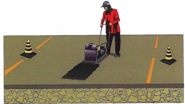
Tipos de compactação em tapa-buraco – placa vibratória
