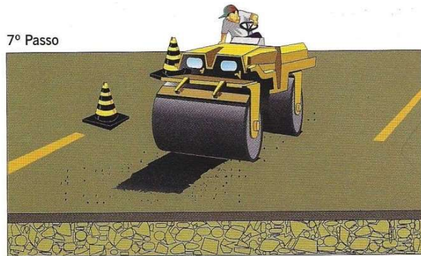
Tipos de compactação em tapa-buraco – rolo compactador
