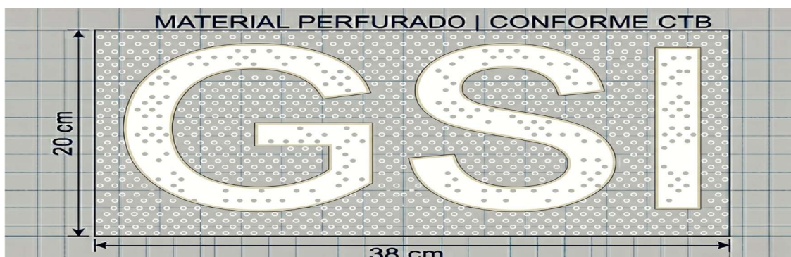
Figura 10: Representação do texto GSI no vidro traseiro do veículo.
