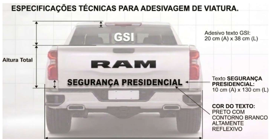
Figura 09: Representação das medidas da retaguarda do veículo.
