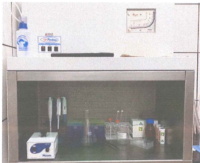
Figura 2: Fluxo laminar horizontal marca Pachane. A lâmpada UV germicida deve ser compatível com este modelo de fluxo laminar.
