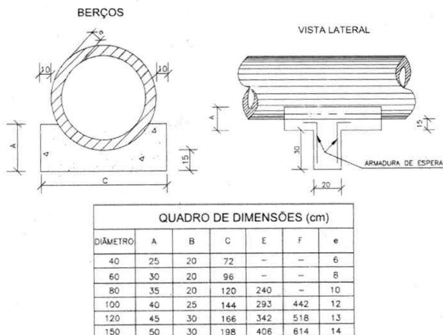
Figura 1: Berço para assentamento de bueiro.
