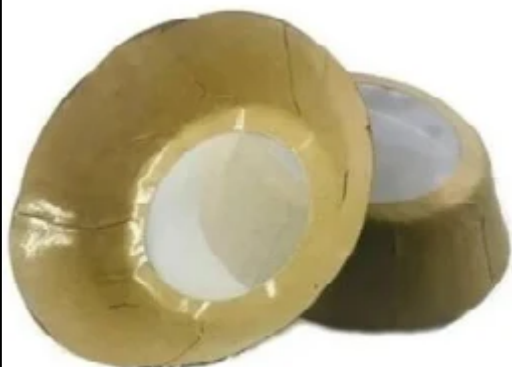
10. Peneira Tipo: Descartável , Material Do Corpo: Papel Kraft , Material Da Peneira: Fio Sintético , Diâmetro Da Borda Superior: 11 CM, Diâmetro Da Borda Inferior: 6,5 CM, Características Adicionais: Filtragem Acima De 6,6 Microns , Aplicação: Tinta - FOTO 10 - " meramente ilustrativa "
