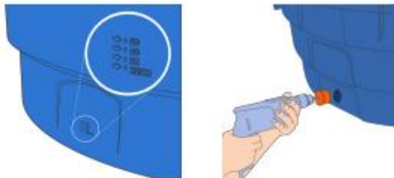
Figura 06 – Execução de furos de saída em conformidade com a indicação do fabricante.
