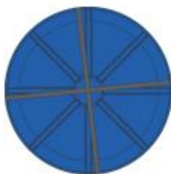
Figura 09 – Cruzamento dos tirantes sobre a tampa da caixa d'água.
