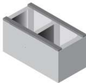
Figura 3 – Dois cordões de argamassa de assentamento
