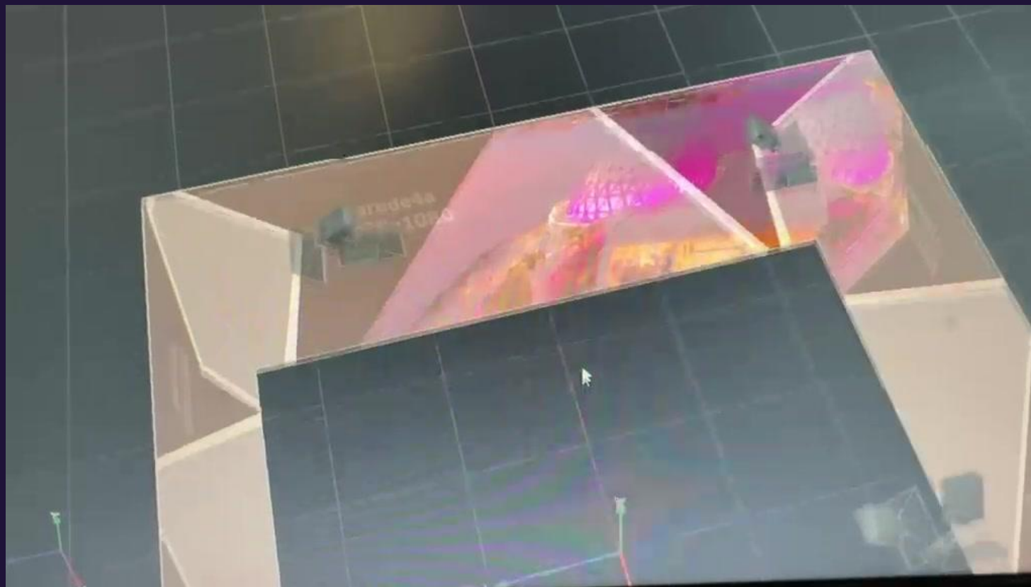
Simulação 3D do posicionamento dos 8 projetores no ambiente 5x5x2,2 m
