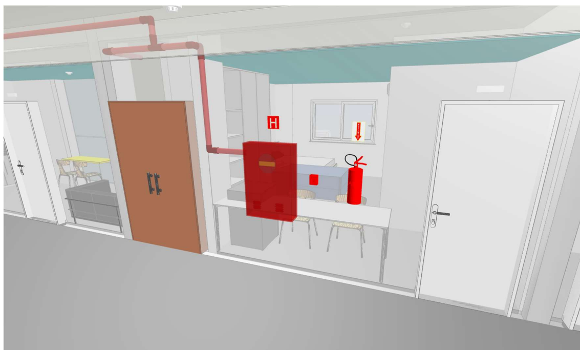
Figura 17 - Hidrante H1 com acionador manual
