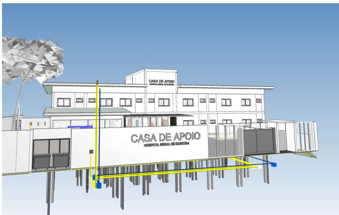
Figura 8 - Perspectiva do projeto de entrada de energia
