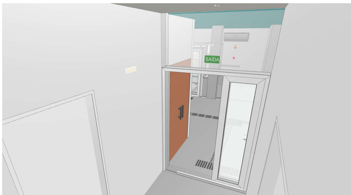
Figura 14 - Sinalização e iluminação de emergência
