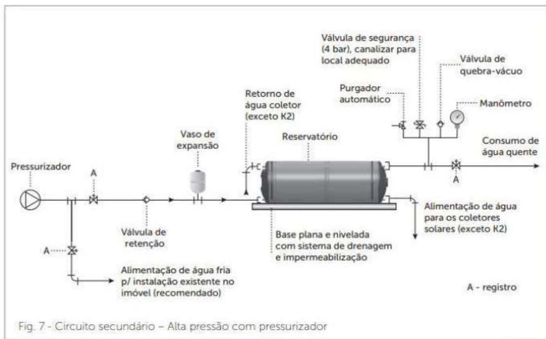
Figura 10 - Sistema de aquecimento de alta pressão
