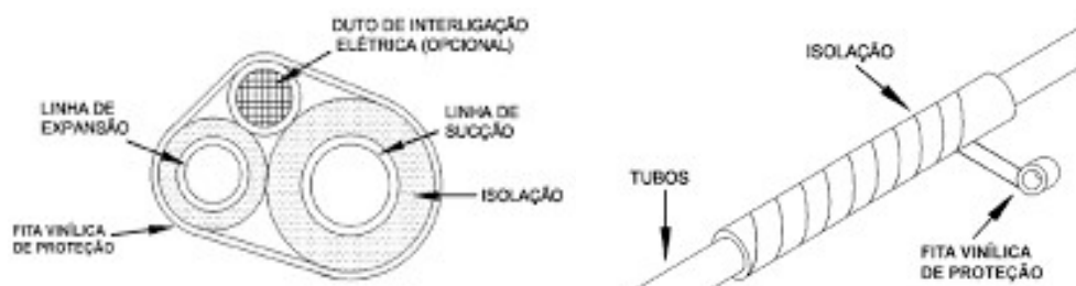
Figura 9 - Tubulação frigorígena revestida com isolante térmico e fita vinílica de proteção
