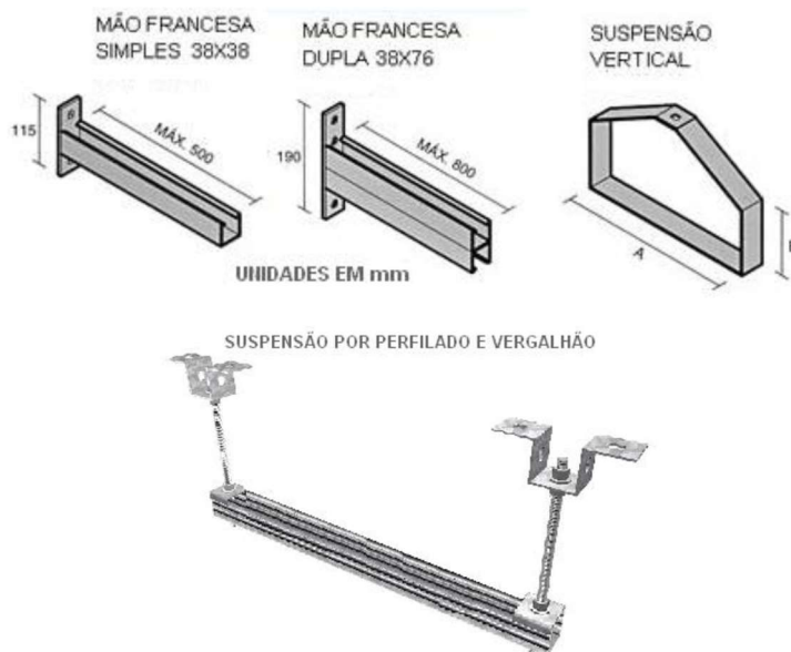
Figura 16 - Acessórios de Eletrocalhas
