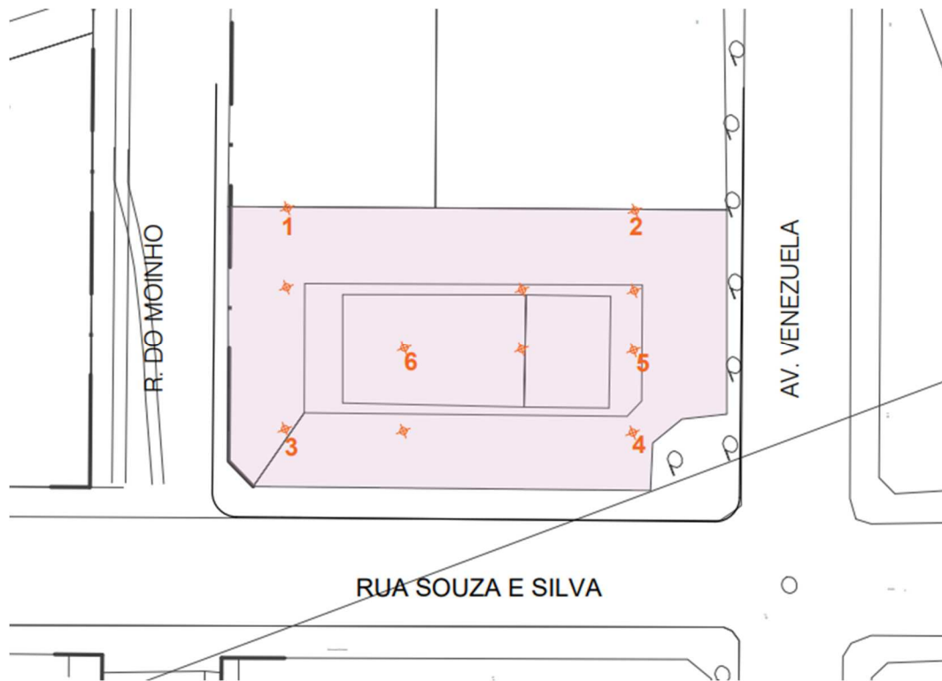
Figura 2- pontos de perfuração da sondagem SPT
