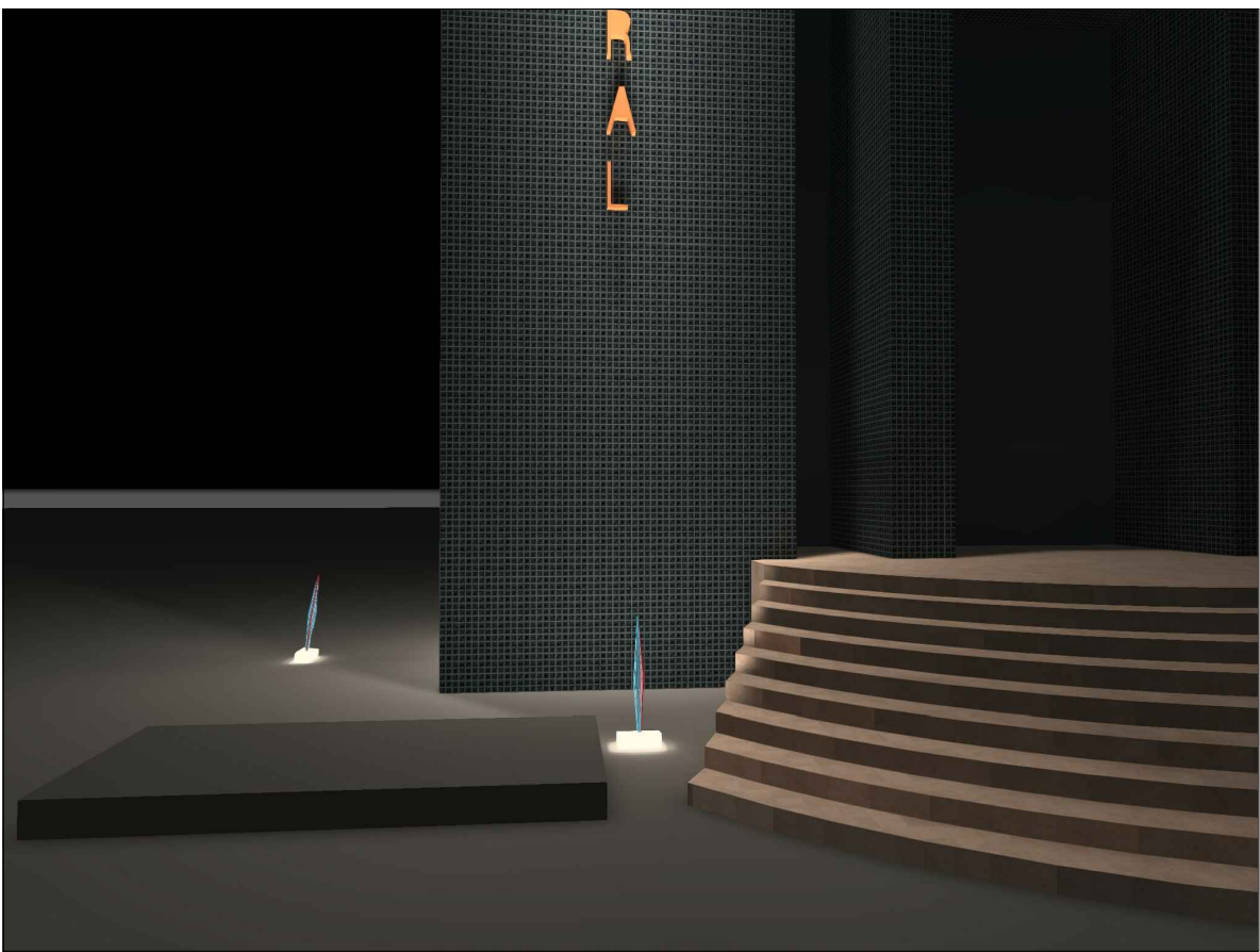
Projetores no solo com curva de distribuição luminosa. Fonte: Gerado pelas autoras no Software DIALux.
