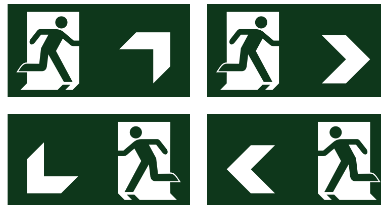
Exemplos de Placas de Orientação e Salvamento
