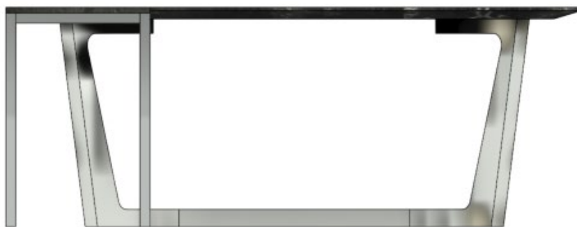
Figura 2 — Vista lateral comparando a base trapezoidal (Mesa 02) e a base reta (Mesa 01).
