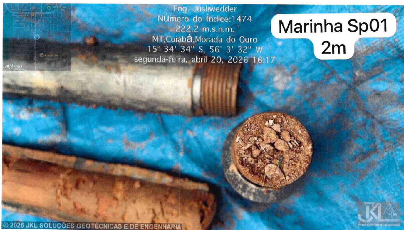
Imagem 6 – Marinha do Brasil - Capit. Fluvial de Cuiabá/MT - Furo SP 01 - Amostra de Prof. 2m, entre 2,00m à 2,45m - 1 Imagem.
