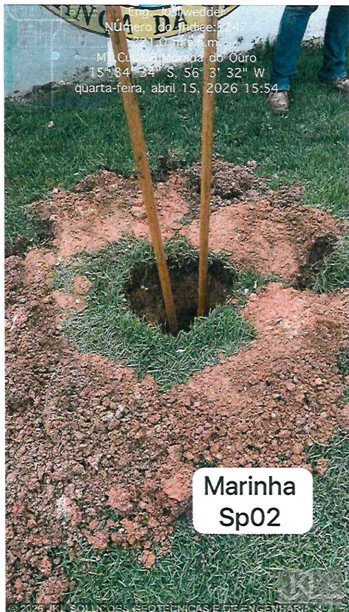
Imagem 14 – Marinha do Brasil - Capit. Fluvial de Cuiabá/MT - Furo SP 02 - Amostra de Prof. Inicial, entre 00,00m à 1,00m - 1 Amostra.
