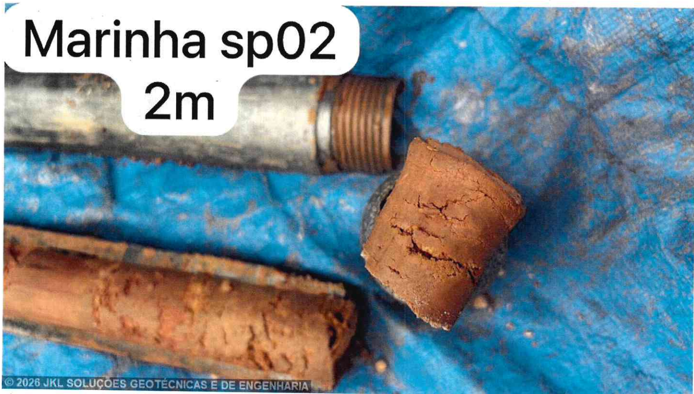
Imagem 17 – Marinha do Brasil - Capit. Fluvial de Cuiabá/MT - Furo SP 02 - Amostra de Prof. 2m entre 2,00m a 2,45m - 1 Imagem.
