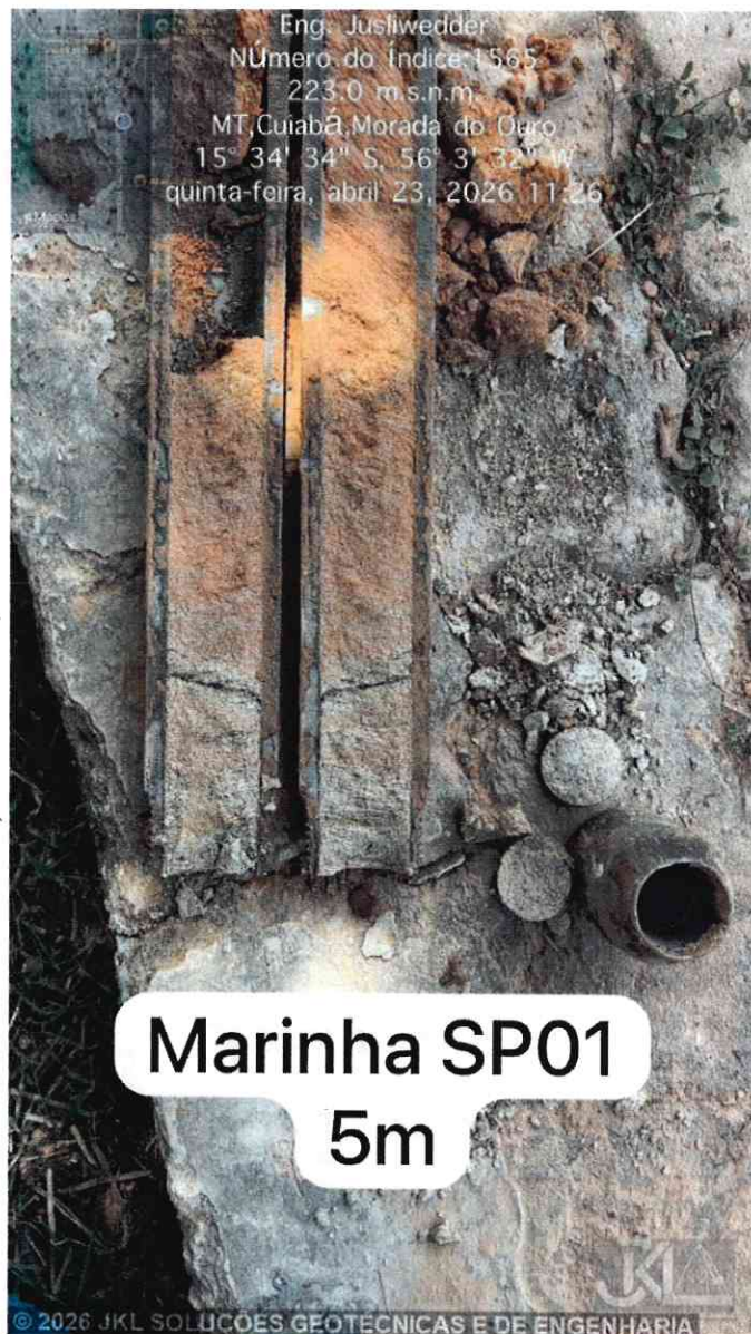
Imagem 9 – Marinha do Brasil - Capit. Fluvial de Cuiabá MT - Furo SP 01 - Amostra de Prof. 5m, entre 5,00m à 6,45m - 1 Amostra.
