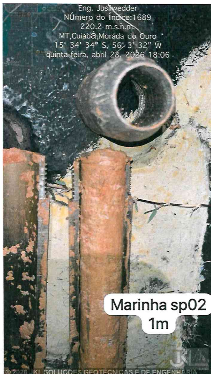
Imagem 15 – Marinha do Brasil - Capit. Fluvial de Cuiabá/MT - Furo SP 02 - Amostra de Prof. 1m, entre 1,00m à 1,45m - 1 Imagem.
