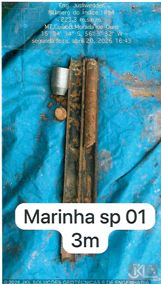
Imagem 7 – Marinha do Brasil - Capit. Fluvial de Cuiabá - Furo SP 01 - Amostra de Prof. 3m, entre 3,00m à 3,45m - 1 Amostra.
