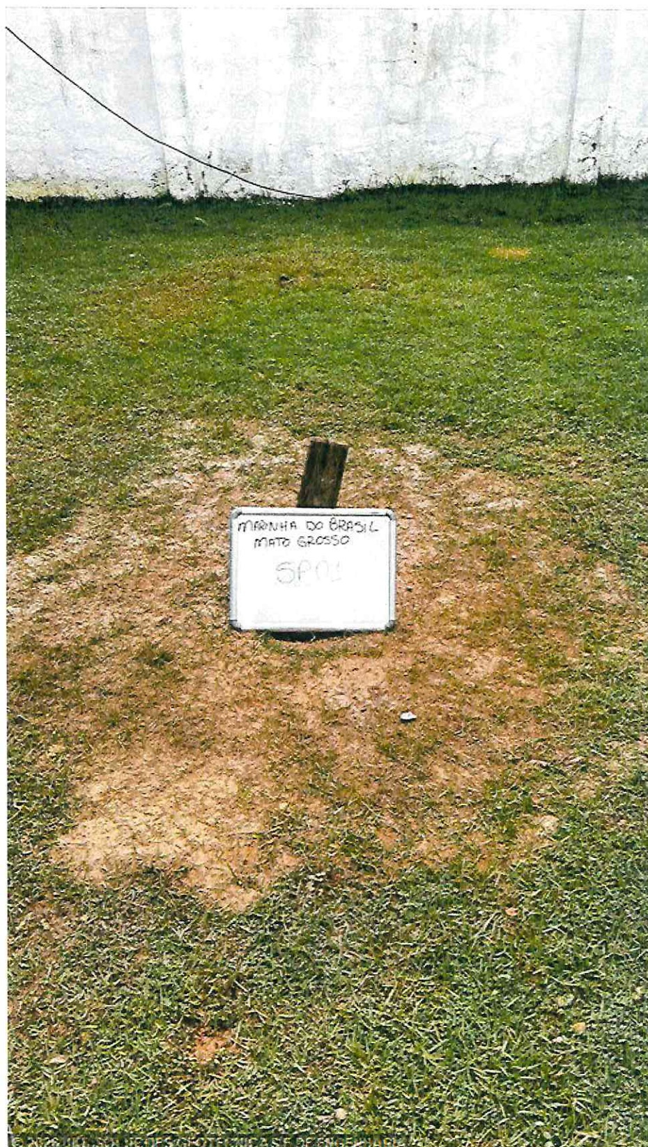
Imagem 11 – Furo Tamponado SP01 ( Proteção do Aquífero, Estabilidade do solo, e Segurança do local NBR 6484/2020)
