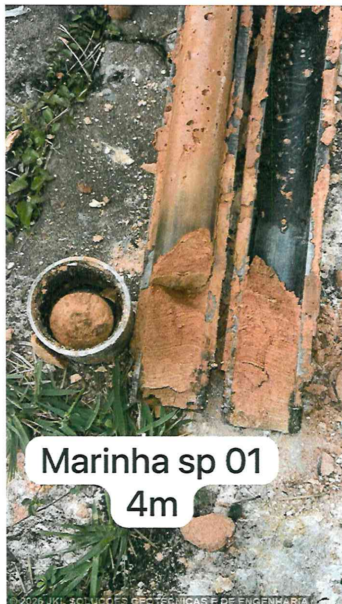
Imagem 8 – Marinha do Brasil - Capit. Fluvial de Cuiabá MT - Furo SP 01 - Amostra de Prof. 4m, entre 4,00m à 4,45m - 1 Amostra.
