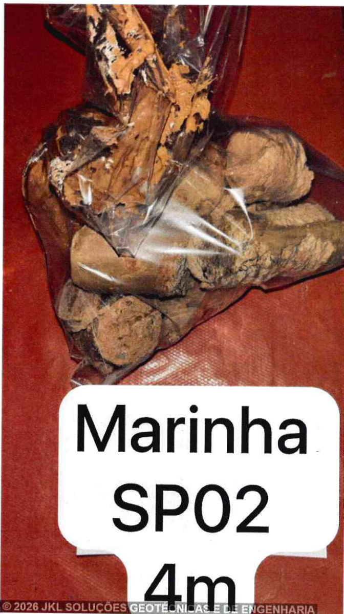
Imagem 20 – Marinha do Brasil - Capit. Fluvial de Cuiabá MT - Furo SP 02 - Amostra de Prof. 4m, entre 4,00m à 4,45m - 1 Amostra.
