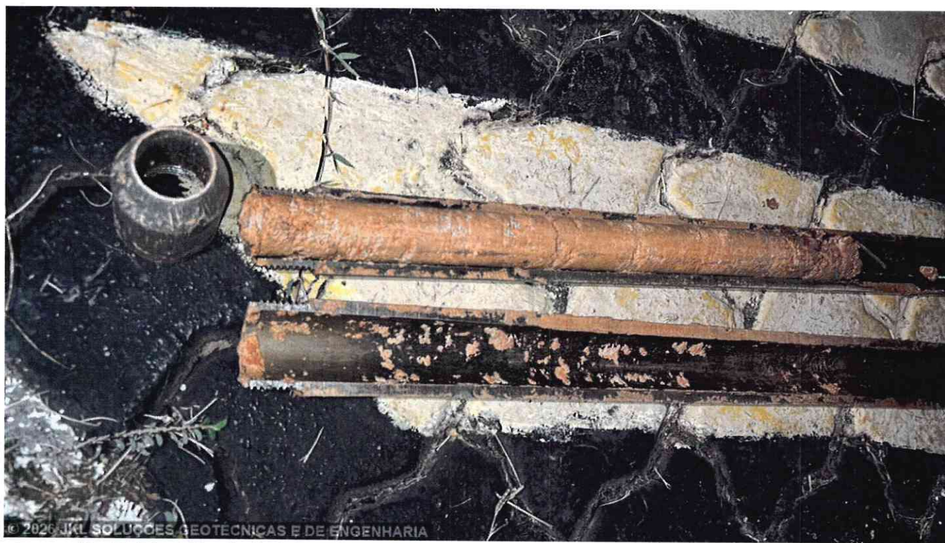
Imagem 16 – Marinha do Brasil - Capit. Fluvial de Cuiabá/MT - Furo SP 02 - Amostra de Prof. 1m, entre 1,00m à 1,45m - 2 Imagem
