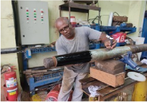
Figura 1 – Aplicação de tinta para execução do teste de contato
