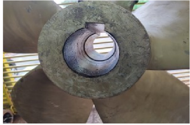
Figura 2 – Teste de contato do hélice com o eixo com 70% de contato
