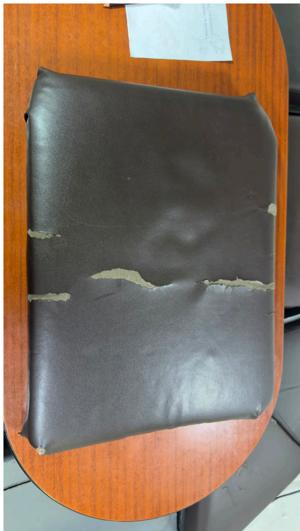
Figura 1 – Almofada vertical apresentando rasgos e desgaste do revestimento.
