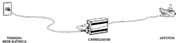
a) Conexões para recarga das baterias
