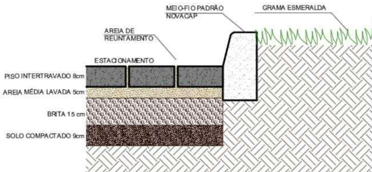
Figura 03 - Estrutura do pavimento intertravado
