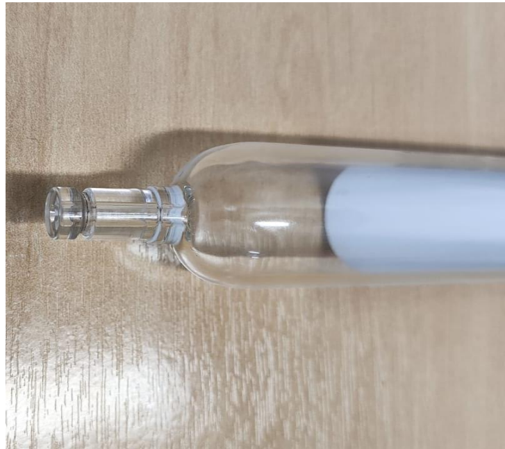
Figura 3 - Detalhe da ponta da peça sem modificação, sem ponta plástica.
