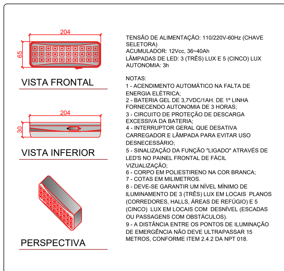
D08 DET. GEN. DE ILUM. DE EMERG. DO TIPO BLOCO AUTÔNOMO Sem Escala
