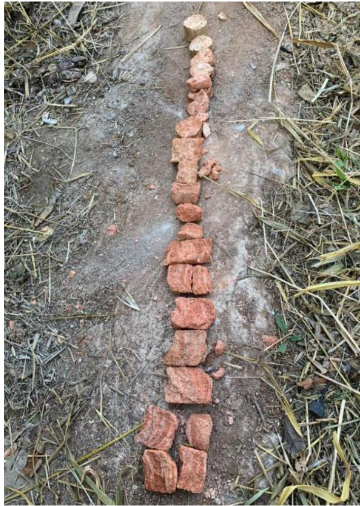
Figura 28 - Materiais amostrados pela Sondagem SPT
