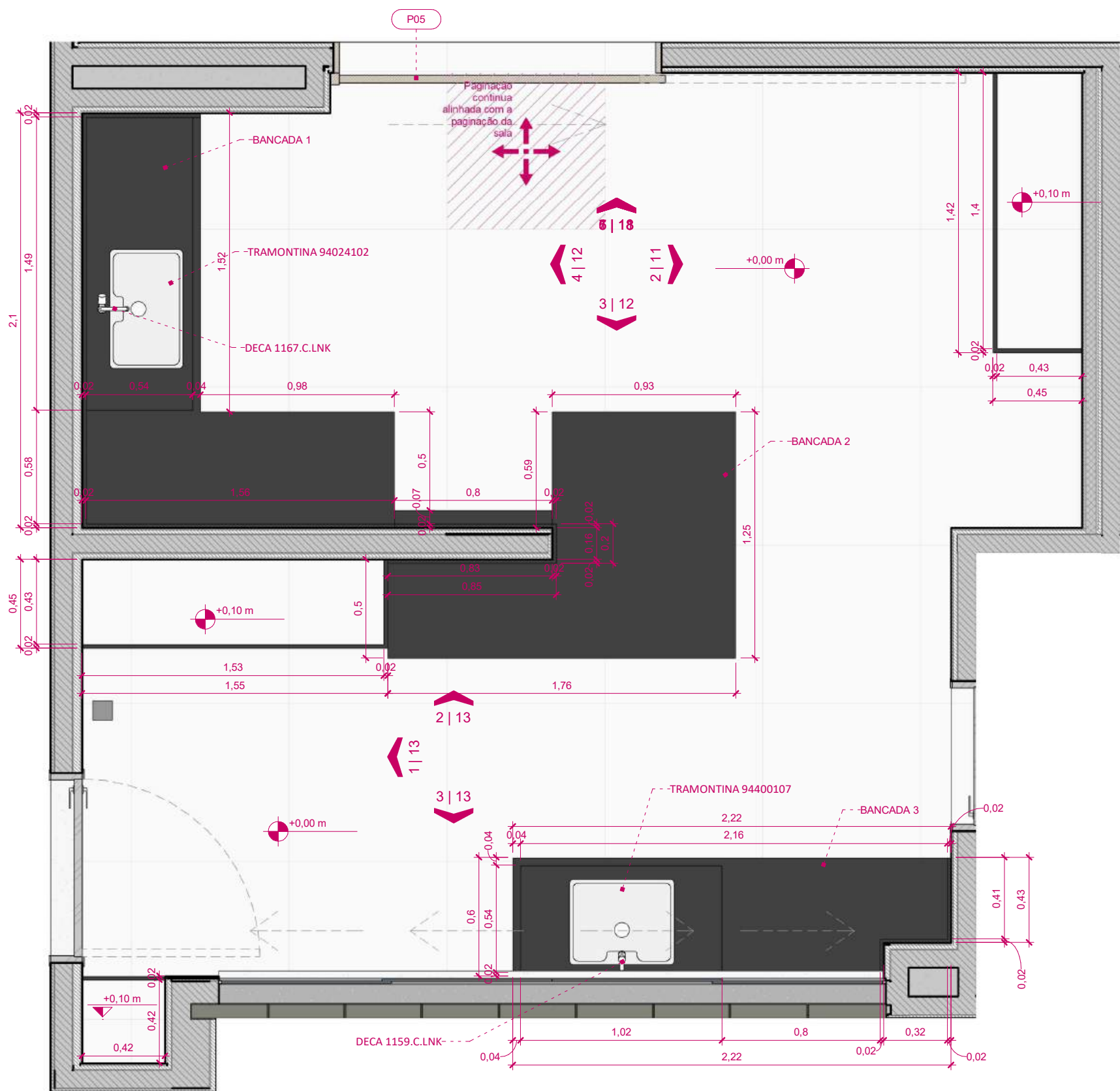
1 Planta Baixa - Detalhe Área de Serviço / Cozinha ESCALA: 1 : 25
