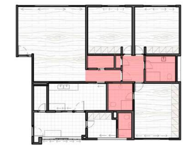
2.3 Indicação de forro a demolir ESCALA: 1 : 200
