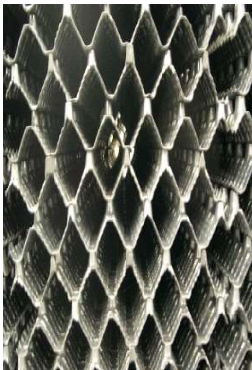
Figura 06 – placas de polietileno (meio suporte) vista de cima.
