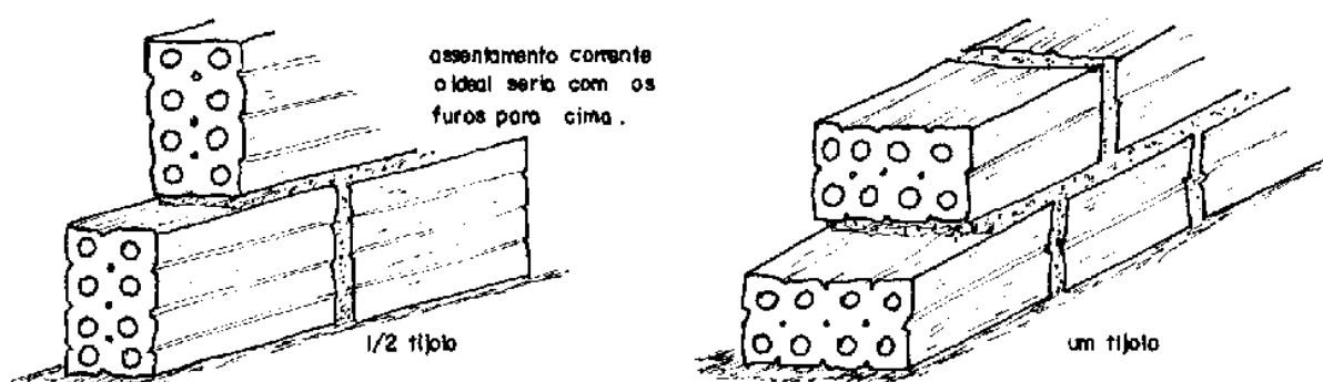
Figura 1 - Execução de alvenaria utilizando tijolos furados.
