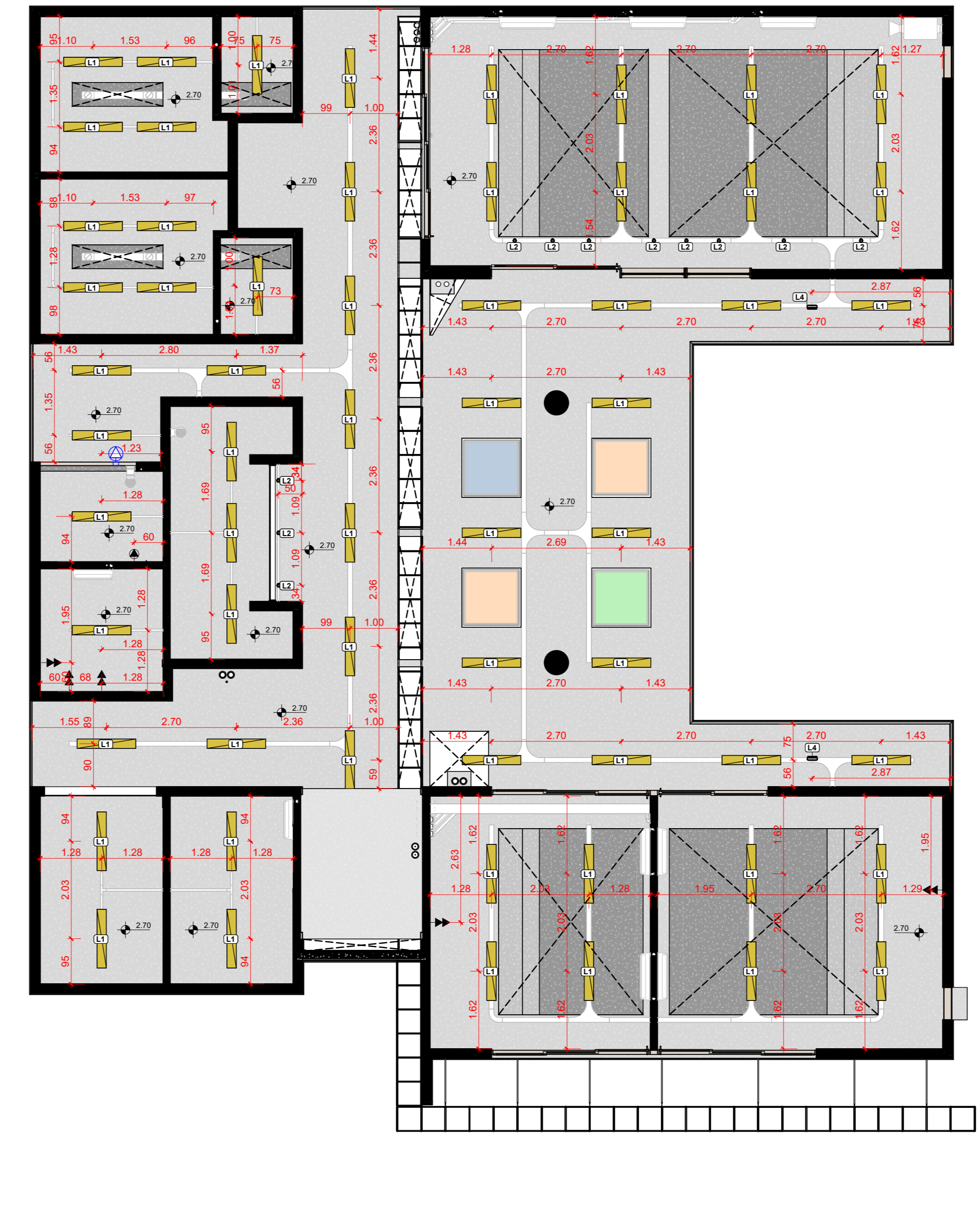
2 A501(NBE00) Planta de Forro Pontos de Elétrica 1:75
