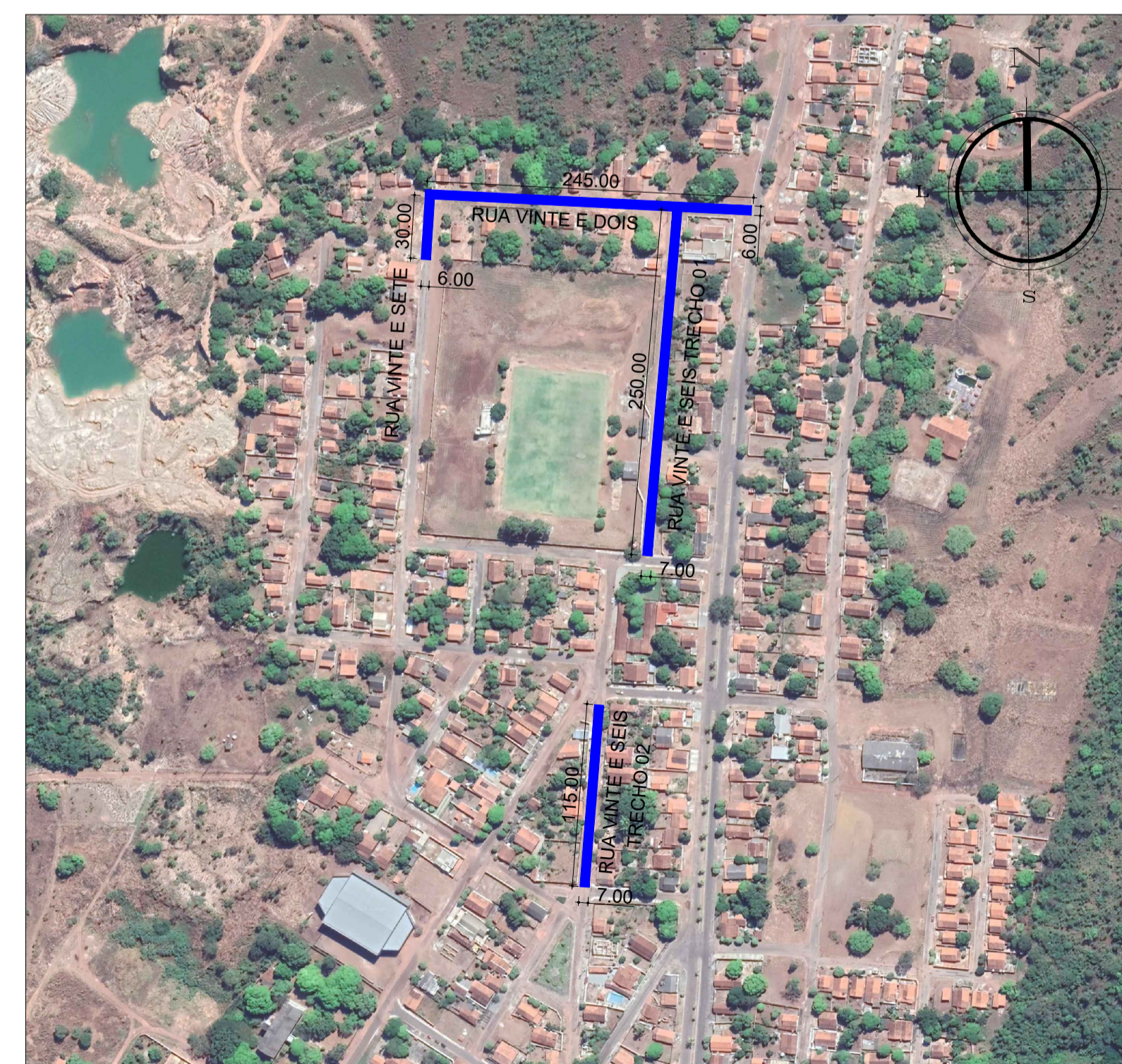
PLANTA DE RECAPEAMENTO
