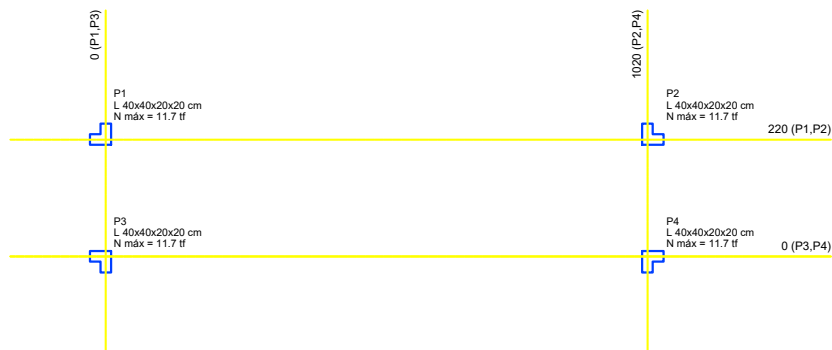
Locação dos pilares da ponte escala 1:50
