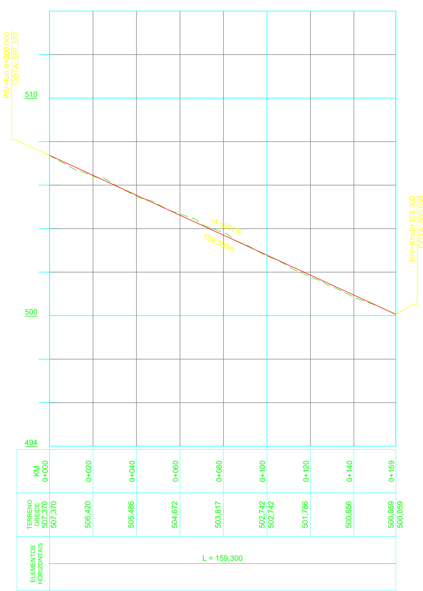
3 PERFIL LONGITUDINAL - VIA RAVENA ESCALA: V:1/100 H:1/1000
