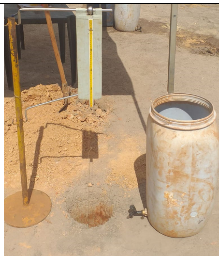
Ft. 03 – Detalhe da checagem rebaixamento.
