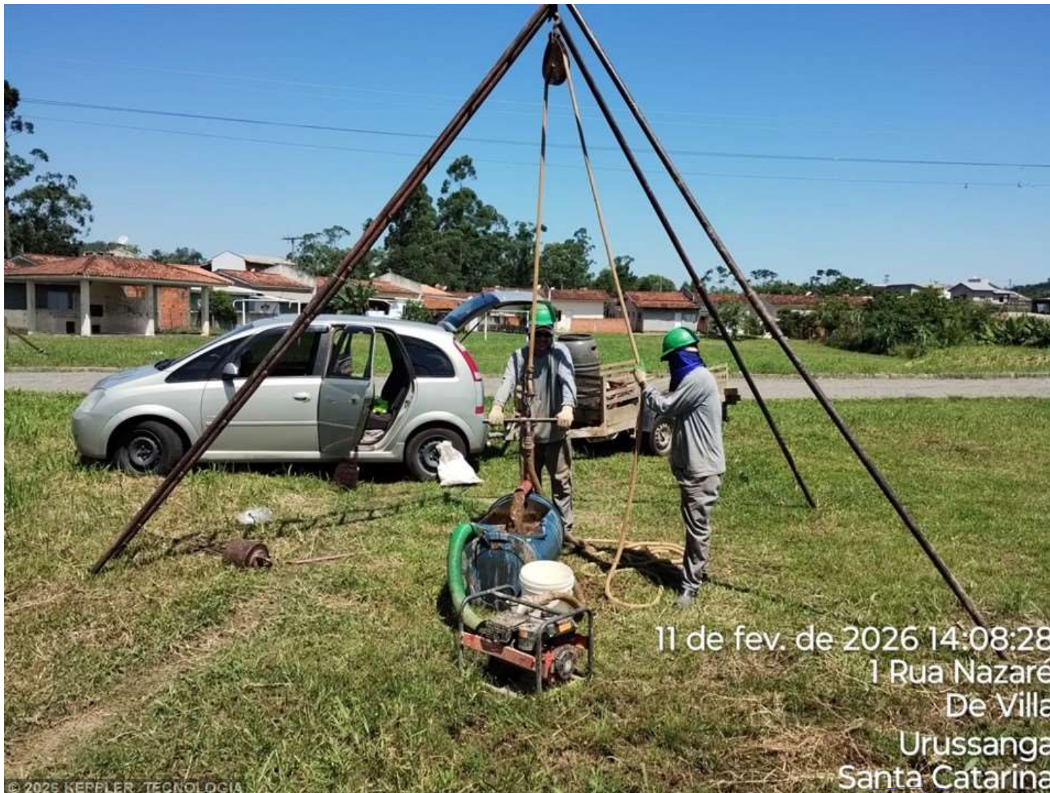
Foto 2 – SPT 5.1 - RUA NAZARÉ - URUSSANGA
