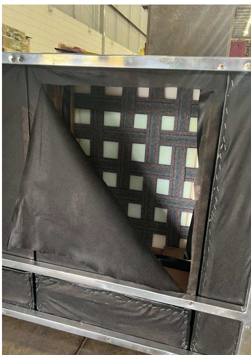
Imagem 03 – Vista interior interna da estrutura em madeira maciça e percinta elástica;
