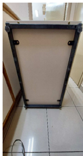
Imagem 04 – Apoio com niveladores de altura
