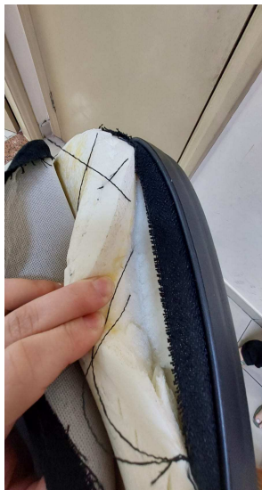
Imagem 03 – Estruturação da espuma do encosto
