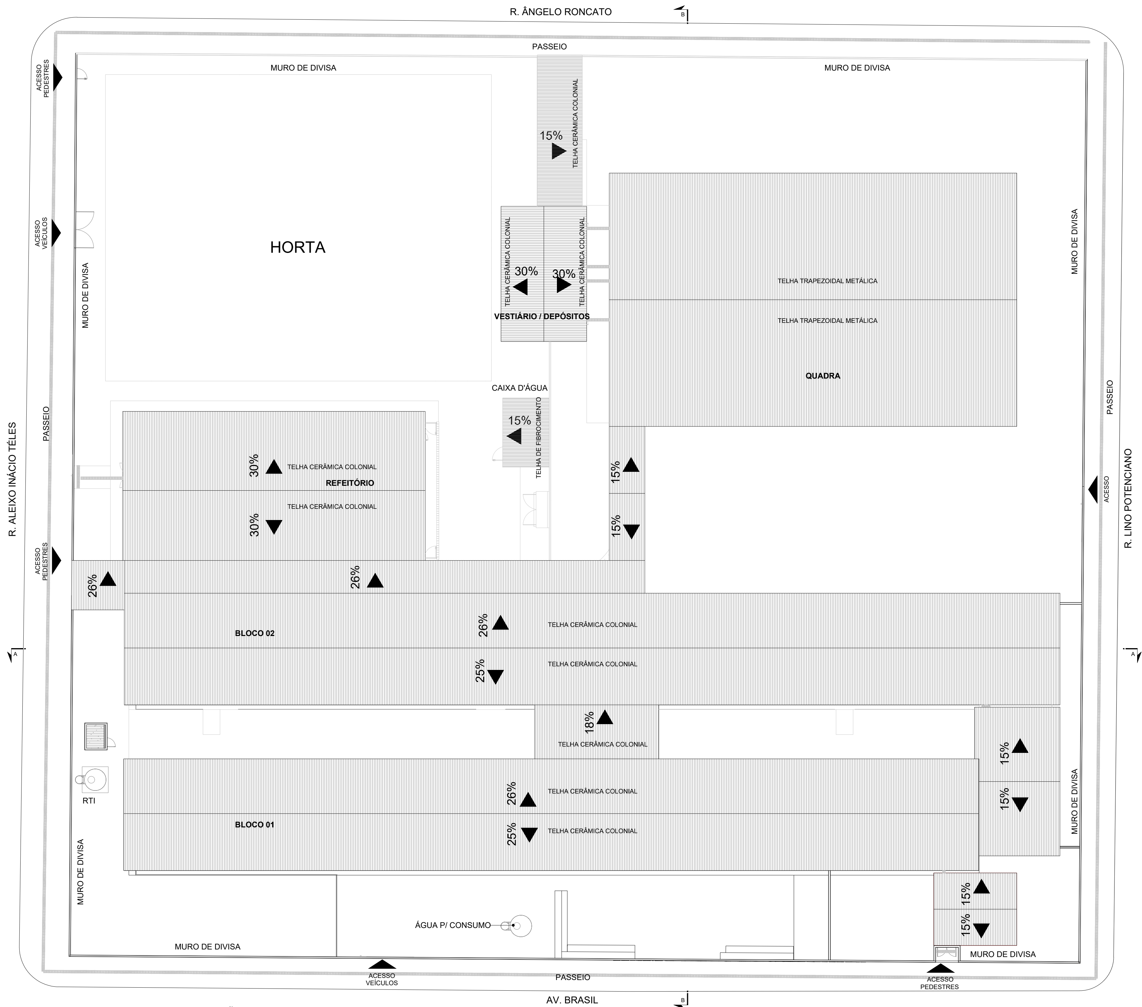
PLANTA COBERTURA / IMPLANTAÇÃO ESCALA 1:200
