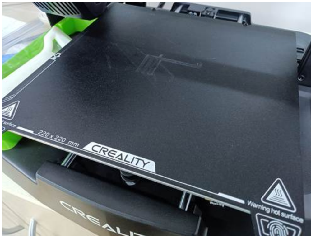
Figura 2: Plataforma de impressão, com área de impressão indicada na serigrafia da placa
