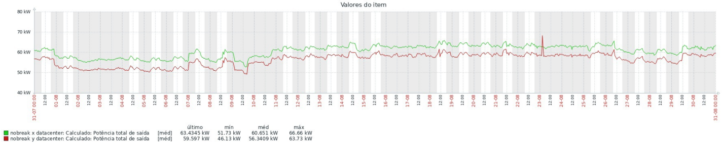
Figura 01 - Data Center SGG – Histórico de consumo (kilowatts - kW) medido no Monitoramento Remoto
