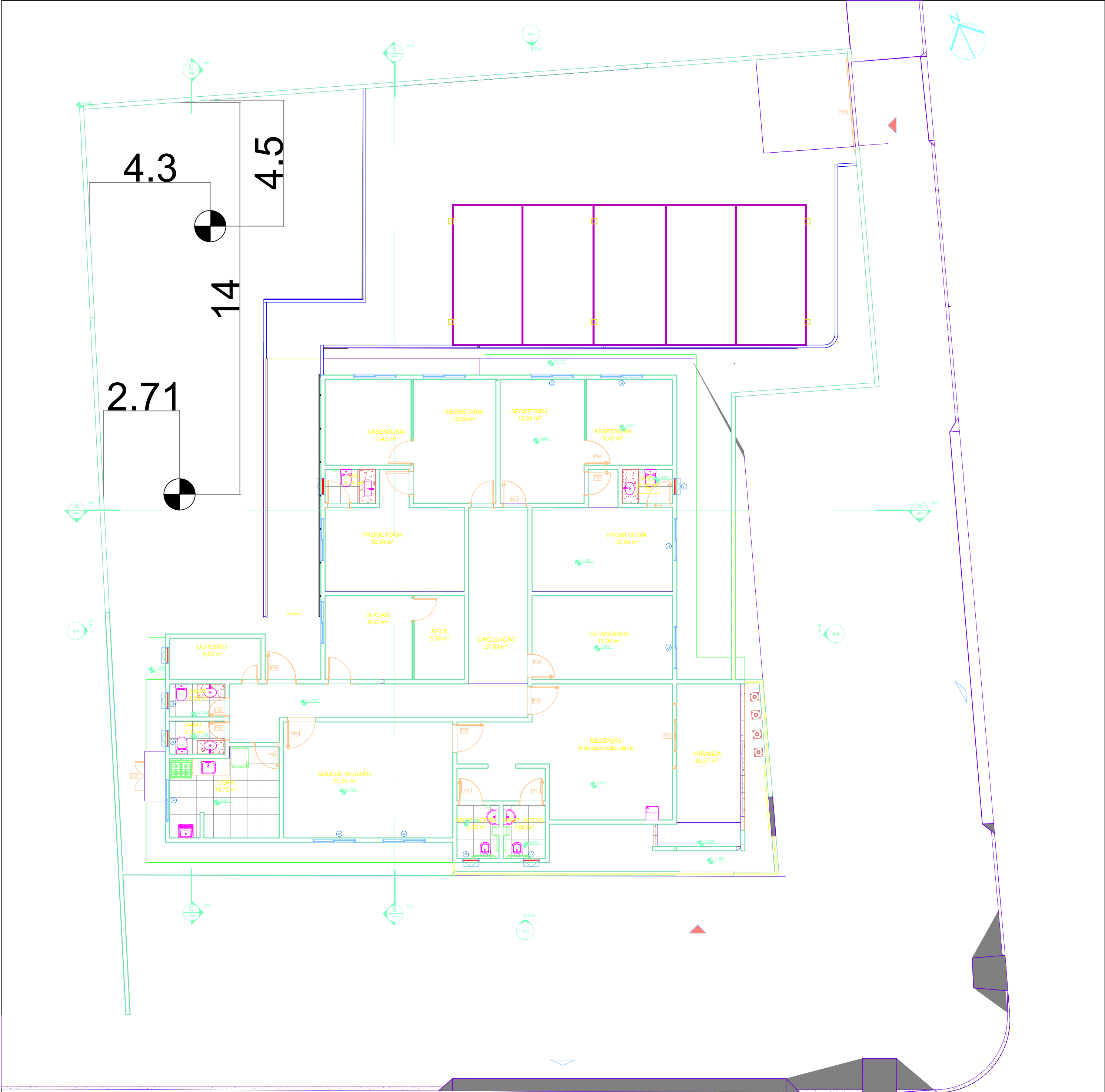
PLANTA MAPA DE LOCAÇÃO DE FUROS DE SONDAGEM ESC.: 1 : 250
