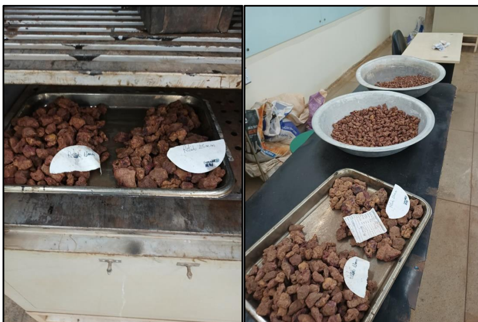
Figura 05 e 06 - Etapa de preparação das amostras para o ensaio de abrasão.
