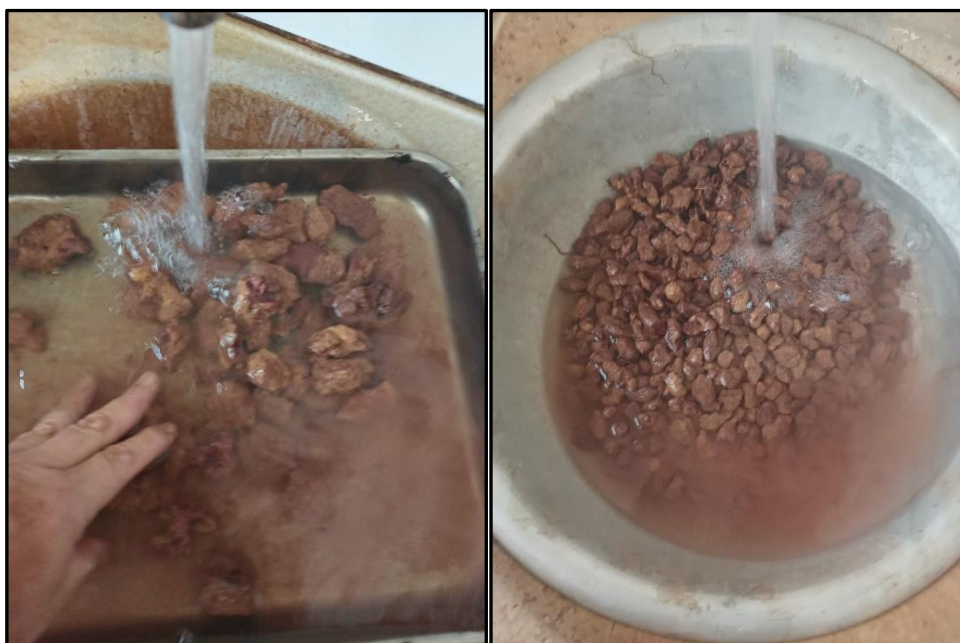
Figura 03 e 04 - Etapa de preparação das amostras para o ensaio de abrasão.
