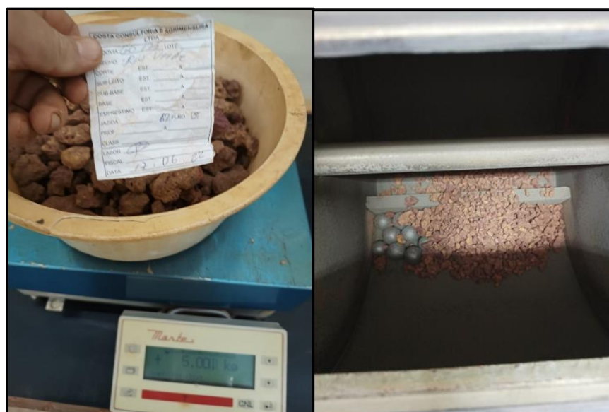
Figura 07 e 08 – Etapas dos procedimentos do ensaio de abrasão Los Angeles.
