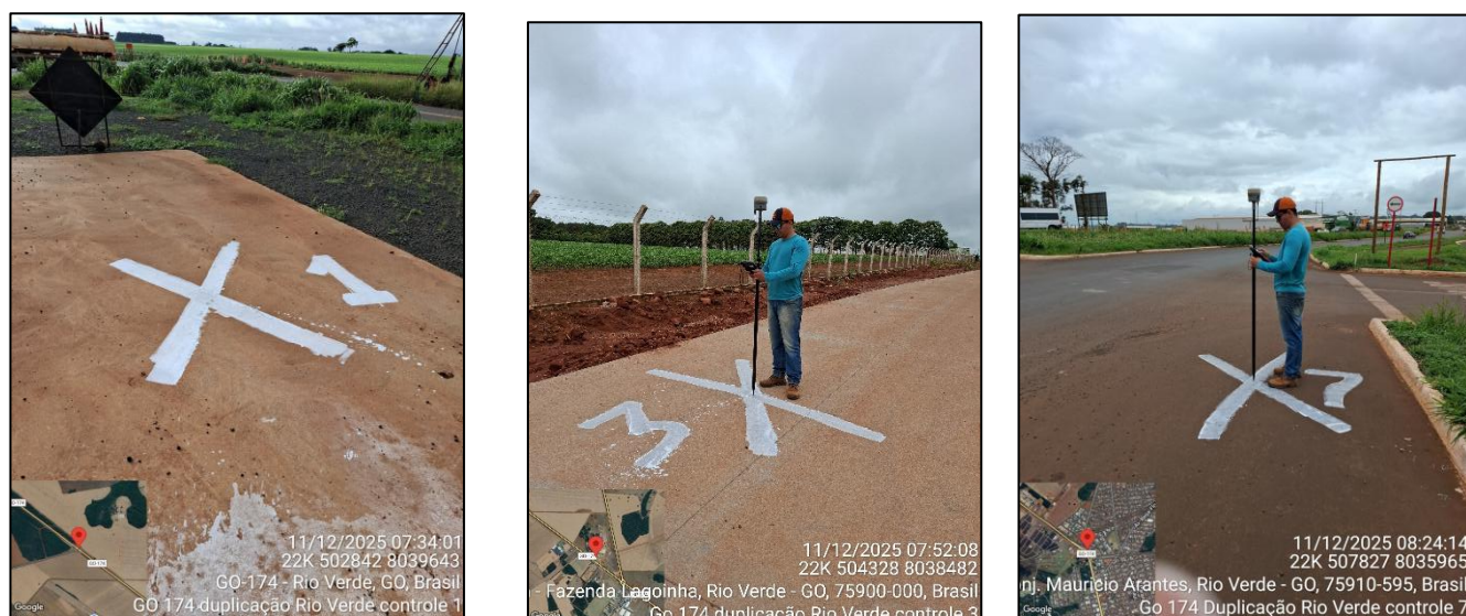
Figura 16 - Registro fotográfico de pontos de controle foto identificáveis para controle 3D das operações de processamento
