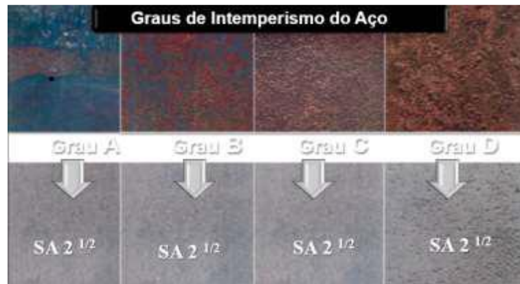
Figura 9 – Padrões de limpeza para as armaduras
