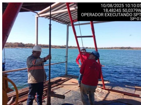
OPERADOR EXECUTANDO SPT
