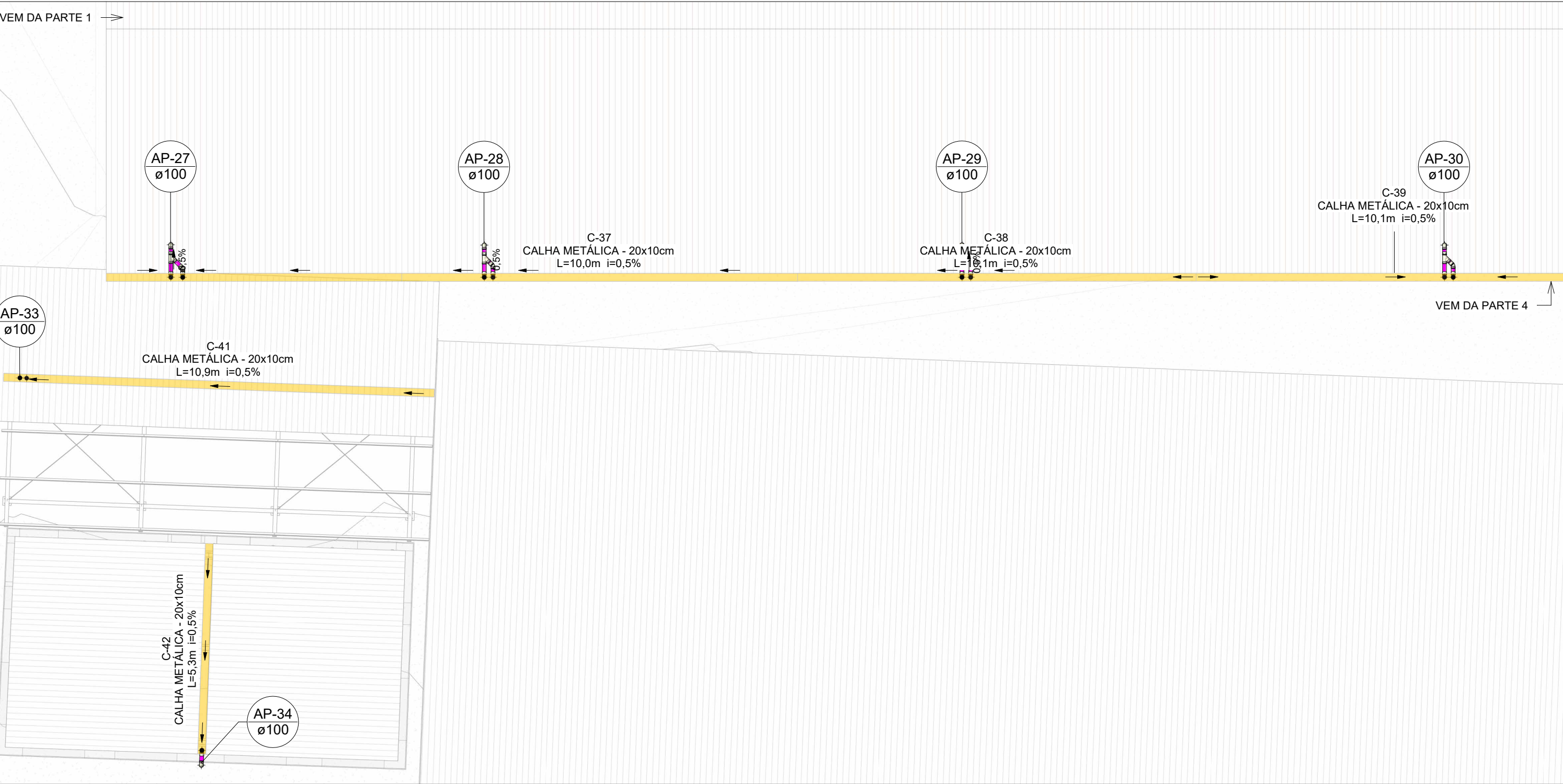
PLANTA BAIXA DRENAGEM PLUVIAL - COBERTURA - PARTE 3
