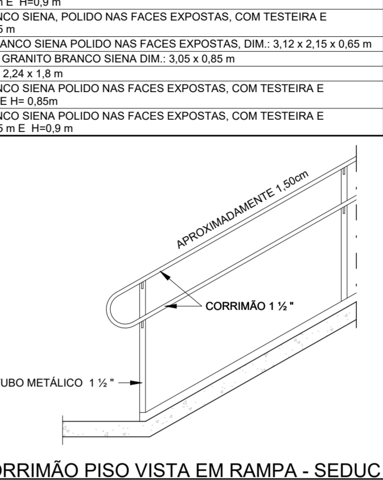
12 CORRIMÃO PISO VISTA EM RAMPA - SEDUC ESCALA 1:25
