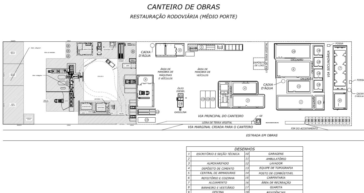
Figura 02 – Áreas referenciais de canteiro de obras.
