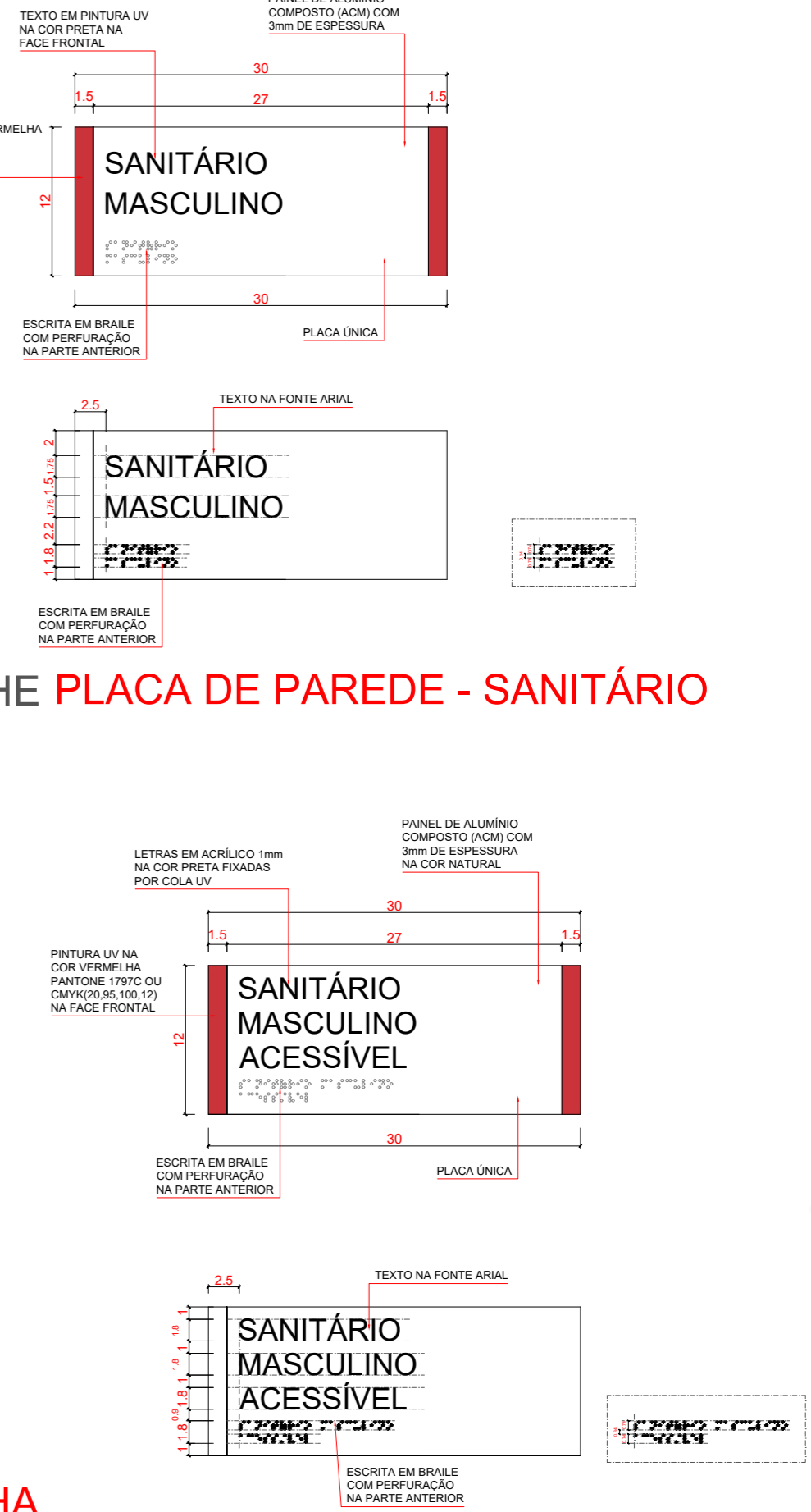
DETALHE PLACA DE PAREDE - SANITÁRIO ACESSÍVEL ESC.: 1 : 5
