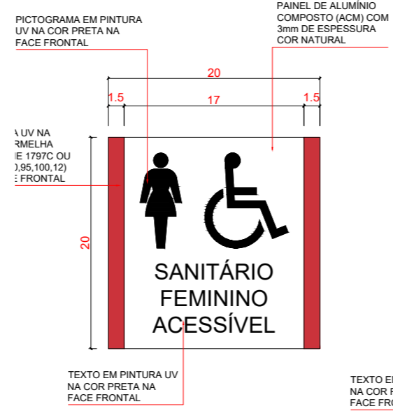
DETALHE PLACA DE PORTA - SANITÁRIO ACESSÍVEL ESC.: 1 : 5
