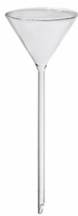
Figura 4: Funil analítico liso com haste longa, nos diversos diâmetros definidos (imagem meramente ilustrativa).
