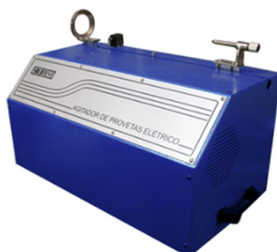
Figura 26: Agitador de provetas elétrico, 220 volts, 60 Hz.
