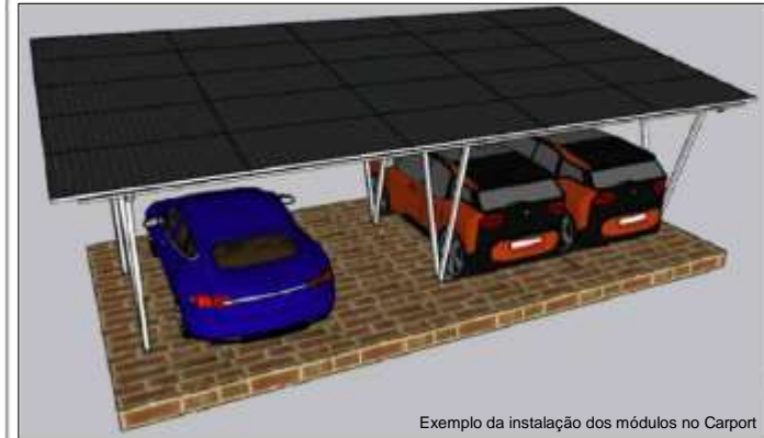
Exemplo da instalação dos módulos no Carport
